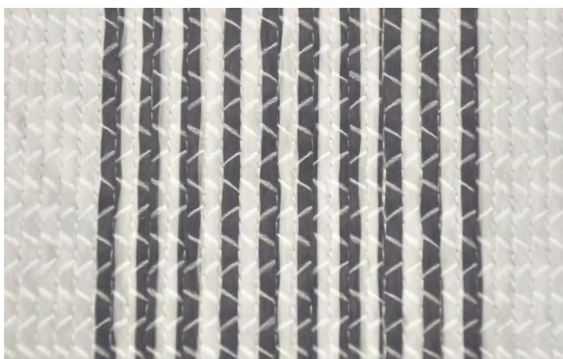
Multiaxiell glasfiber-matta med kolfiberinlägg.
