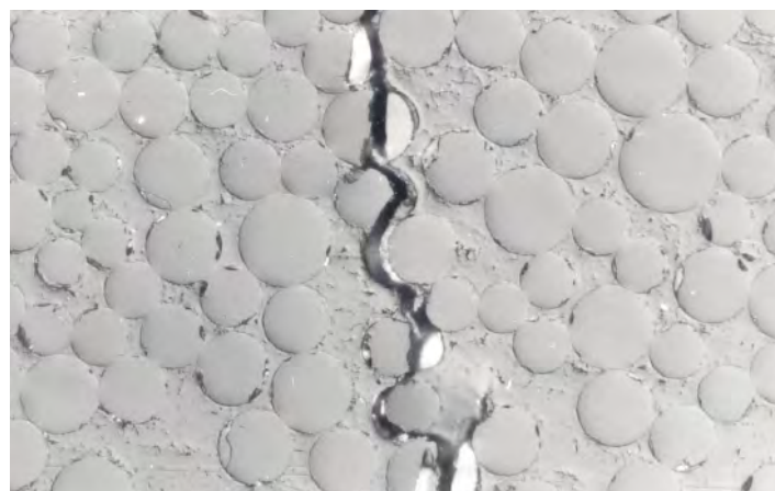
Transversell spricka i glasfiberarmerad vinylester. Sprickan uppstod vid hög töjning (> 0.6%) tack vare starkt fäste mellan fibrerna och plasten.
