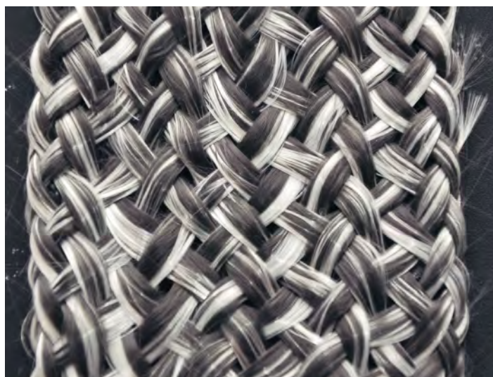
Flätad strumpa bestående av en kombination av glasfiber och polypropenfiber (hybridgarn).
