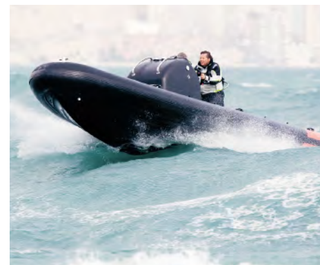
RIB-båt med skrov tillverkat av kolfiberarmerad epoxi.
